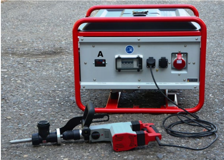
Abb. 20 Ein Betriebsmittel angeschlossen ohne weitere Schutzmaßnahme
